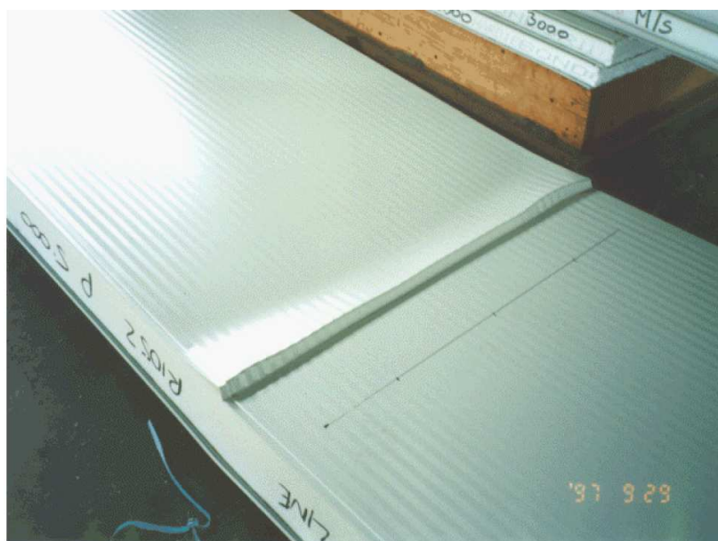
Rottura per raggrinzimento della lamiera superiore compressa
